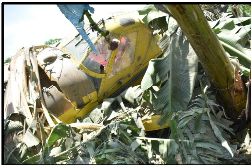
Fotografía No. 8 Vista de los daños de la cabina.
