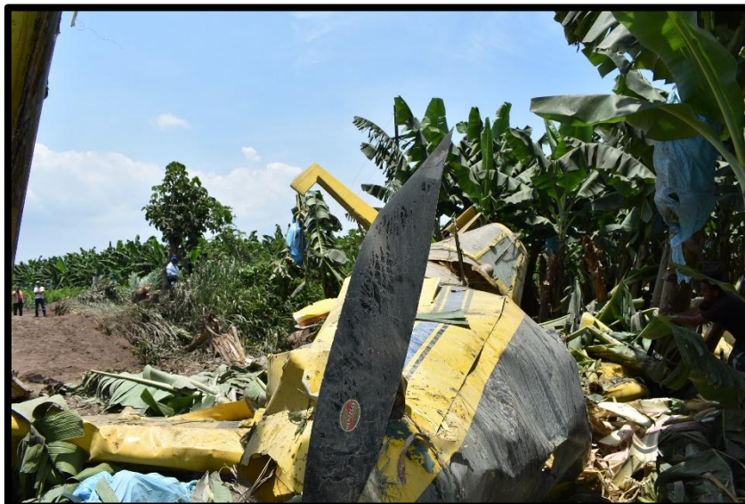
Fotografía No. 6 Vista frontal y daños a la hélice.
